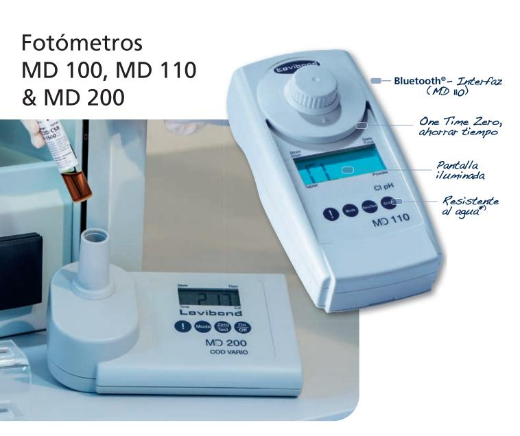
La medición se realiza con filtros de interferencia de alta calidad y como fuente de luz LEDs de larga vida estable, sin partes móviles, en una cámara de medición transparente.
